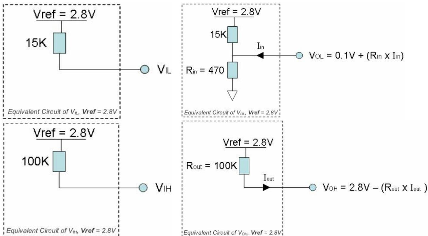
Если на вход **Vref** подано напряжение >2.8V, к портам ввода-вывода можно подключать компоненты, соответствующие следующим уровням сигналов:
