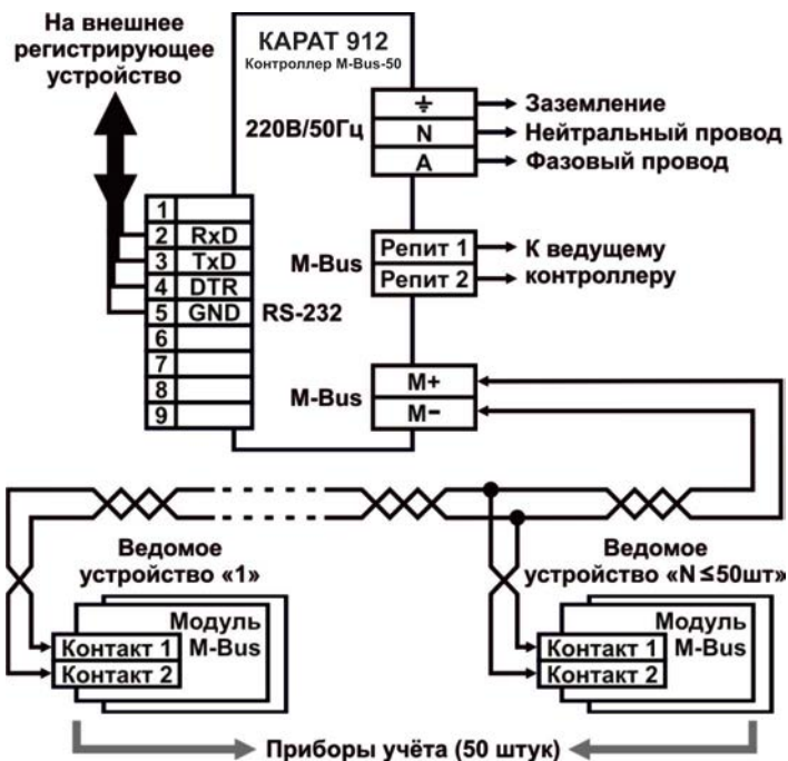
Рисунок 3 – Подключение ведомых устройств к контроллеру
