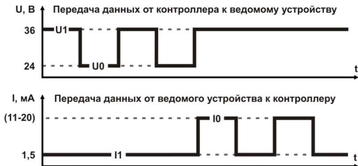
Рисунок 1 – Представление битов данных в интерфейсе M-Bus
