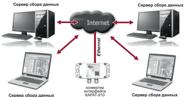
Рисунок 5 – Основные варианты применения конвертера при организации верхнего уровня АССПД
