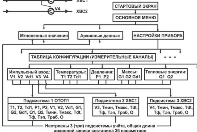
Рисунок 2.5 – Пример реализации алгоритма настройки вычислителя
